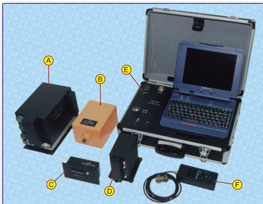
A - Blok Akwizycji S3-1a-2; B - Kasetka Ochronna S2-3a-K; C - Pulpit Indeksu Pilotów S2-3a-P; D - Czytnik Kaset S3-1c-O; E - Komputerowy Tester WTS4; F - Tester WTS4/AP702C
