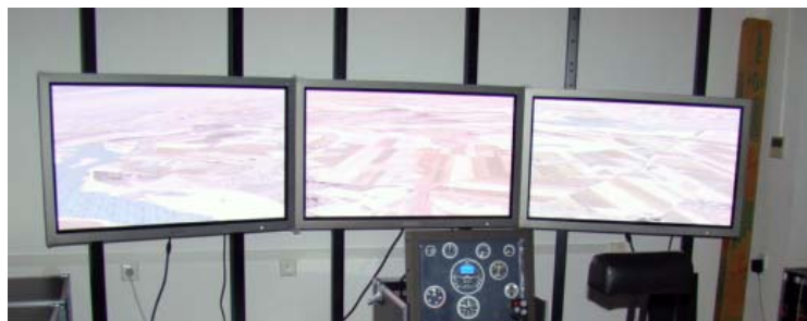
System wizualizacji zainstalowany w laboratorium HMI
