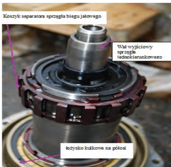
Rys. 3.70. Węzeł lewego sprzęgła jednokierunkowego po wymontowaniu z korpusu przekładni głównej WR-24 Po zdemontowaniu zespołu sprzęgła biegu jałowego (rys. 3.73, elementy grupy „a” i „b”) ukazują się napędowe koło zębate Z33 (zamontowane zarówno na wale wielowypustowym lewego, jak i prawego sprzęgła). Koła Z33 mają jednakową konstrukcję i napędzają jednocześnie koło zębate Z95. Zęby skośne wyważają siłę osiową F . Znaczna moc przenoszona przez węzły sprzęgła jednokierunkowego oraz wysoka prędkość obrotowa (250 obr/s) powodują, że pomiędzy zazębiającymi się kołami Z33 i Z95 wytwarzane są znaczne siły poosiowe F . Jedyną oporą przed poosiowym przemieszczaniem się zespołu sprzęgła jednokierunkowego jest tuleja dystansowa 8. Tuleja ta jest blo-
