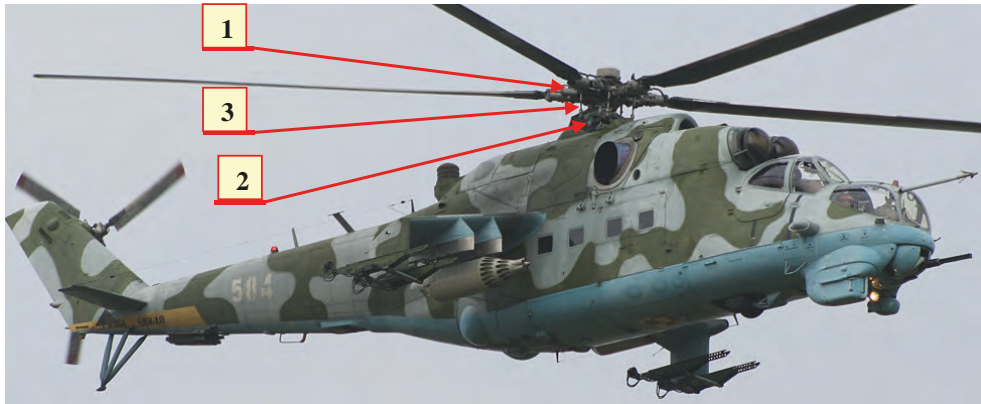
Rys. 3.62. Śmigłowiec Mi-24W, będący obecnie na wyposażeniu SZ RP: 1 – pisata (głowica) śmigła głównego; 2 – tarcza sterująca (w położeniu neutralnym – płaszczyzna górnego, tj. ruchomego, talerza w położeniu poziomym, ekstremalnie nisko); 3 – popychacz (jeden z pięciu) [fot. Wikipedia, Radosław Idaszak]
