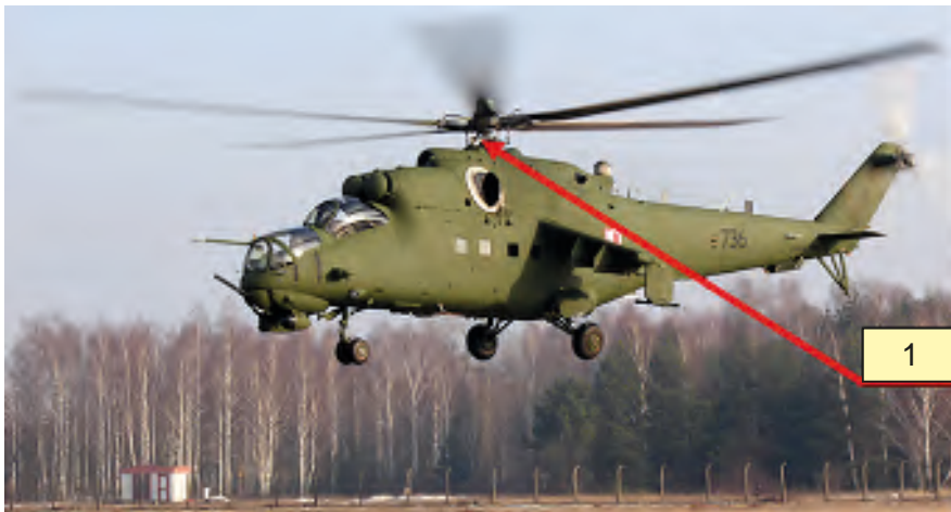
Rys. 3.63. Mi-24 w zawisie z powolnym przemieszczaniem do przodu: 1 – tarcza sterująca – płaszczyzna górnego, tj. ruchomego, talerza w położeniu pochylonym do przodu, ekstremalnie wysoko
