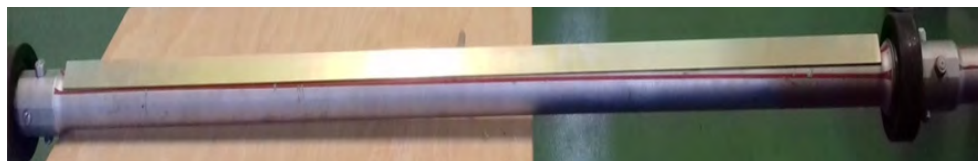
Rys. 6.29. Wał środkowy: 1 – linia kontrolna naniesiona farbą na wale w czasie procesu wytwórczego (remontowego) – widoczne znaczne skrzywienie wału; 2 – przymiar kontrolny
