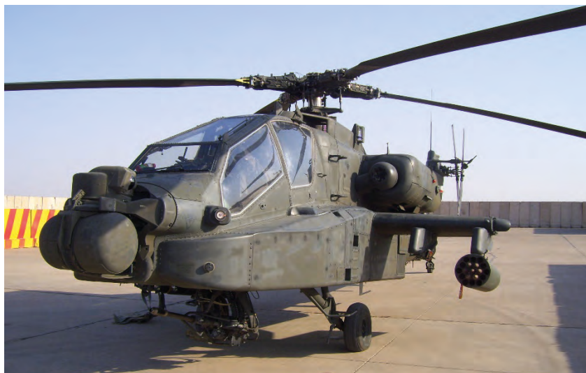
Rys. 3.6. Amerykański śmigłowiec bojowy AH-64 Apache – widok z przodu; w nosie śmigłowca widoczne elementy systemu celowniczo-rozpoznawczego
