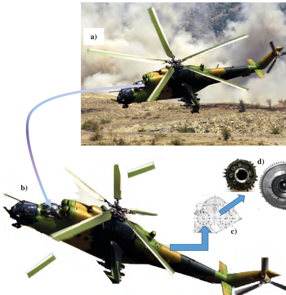
Rys. 7.1. Śmigłowiec Mi-24 z przerwanym systemem transmisji w kierunku śmigła ogonowego – na skutek uszkodzenia wewnętrznego w skrzynce napędu prądnic (Afganistan 2011): a) śmigłowiec w czasie lotu – przerwanie napędu na śmigło ogonowe powoduje jego przechylenie na lewą burtę i skręt w lewo; b) śmigłowiec po zetknięciu się z płaszczyzną lotniska; c) skrzynka napędu agregatów (SNA) po wyrwaniu się z poszycia belki ogonowej; d) – wyłamane zęby w SNA będące przyczyną przerwania transmisji mocy do wirnika śmigła ogonowego
