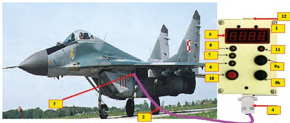
Rys. 4.12. Sposób podłączenia testera diagnostycznego DIA-KSA-CM do samolotu MiG-29: 1 – obudowa testera diagnostycznego DIA-KSA-CM; 2 – kabel łączący tester z pokładową siecią elektroenergetyczną prądu przemiennego 1x115 V, 400 Hz; 3 – złącze elektryczne we wnęce lewego podwozia; 4 – złącze CANON DB9 obwodu wejściowego testera; 5 – wyświetlacz; 6 – dioda LED koloru zielonego sygnalizująca stan bezpiecznej eksploatacji; 7 – dioda LED koloru żółtego sygnalizująca stan częściowego zużycia; 8 – dioda LED koloru czerwonego sygnalizująca stan zagrożenia awarią lub stan awarii; 9 – przyciski manipulacyjne („+” i „-”) do wprowadzania numeru samolotu, oznaczania silnika oraz do przeszukiwania danych diagnostycznych dla danego testu; 9a – przycisk manipulacyjny „+” (po jego naciśnięciu przed testem następuje zmiana rosnąca wprowadzanego numeru taktycznego SP; po jego naciśnięciu po teście wyświetlony zostaje symbol elementu mechanicznego zespołu napędowego o wyższym poziomie zużycia); 9b – przycisk manipulacyjny „-” (po jego naciśnięciu przed testem następuje zmiana malejąca wprowadzanego numeru taktycznego SP; po jego naciśnięciu po teście wyświetlony zostaje symbol elementu mechanicznego zespołu napędowego o niższym poziomie zużycia); 10 – przycisk włączania testu START; 11 – dioda LED koloru pomarańczowego sygnalizująca trwanie testu; 12 – złącze do przyłączania komputera (do odczytu danych zawartych w pamięci testera)
