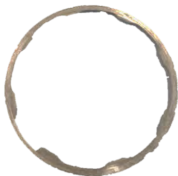
Rys. 6.38. Fotografia pierścienia dociskowego bieżni wewnętrznej łożyska głównego tarczy sterującej (wyjętego z gniazda łożyskowego) z kompletu uszkodzonej tarczy sterującej – widoczne ubytki materiałowe
