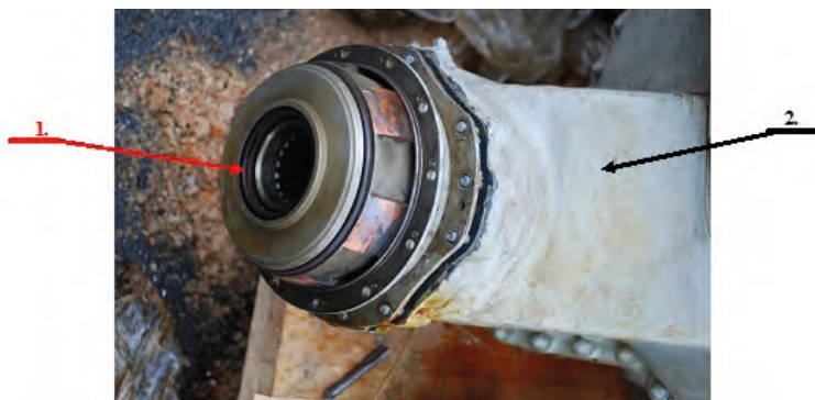
Rys. 3.69. Wejście wielowypustowe do pólki sprzęgła jednokierunkowego w przekładni głównej WR-24: 1 – wielowypust wewnętrzny; 2 – odlew korpusu sprzęgła jednokierunkowego
