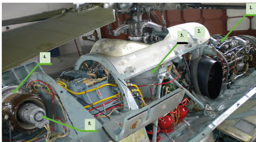
Rys. 3.40. Rozmieszczenie elementów zespołu napędowego śmigłowca Mi-24 (rysunek poglądowy): 1 – silnik napędowy TW3-117MT; 2 – wentylator; 3 – przekładnia główna WR-24; 4 – turborozrusznik AI-9W; 5 – prądnica-rozrusznik STG-3 (z kompletu turborozrusznika AI-9W) [fot. Tomasz Radoń]
