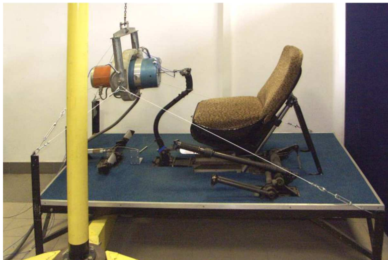
Rys. 4. Stanowisko do badania wpływu pilota na układ sterowania
