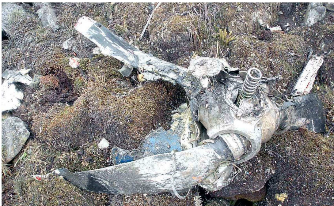
Rys. 3. Charakterystycznie duże uszkodzenia śmigła pracującego na wysokich obrotach po zderzeniu z twardym podłożem (skałą); śmigło oderwane od samolotu i pozbawione jednej łopaty [źródło: Raport nr 660/13 PKBWL]
