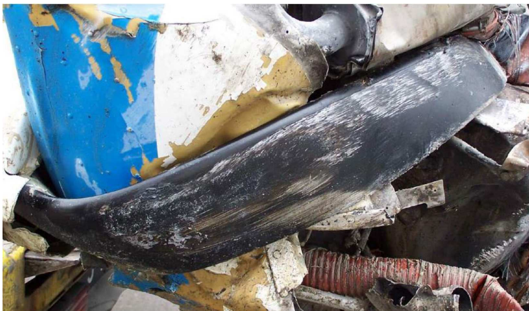
Rys. 2. Charakterystyczne cechy uszkodzeń śmigła na małych obrotach zatrzymanego podczas zderzenia z twardym podłożem z widocznymi śladami ciągnięcia podwiniętej łopaty, druga łopata pozostała nienaruszona [źródło: Raport nr 91/05 PKBWL]
