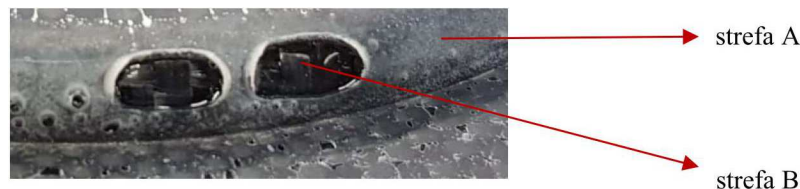
Rys. 1. Efekt niewystarczającego docisku na złożonej geometrii
