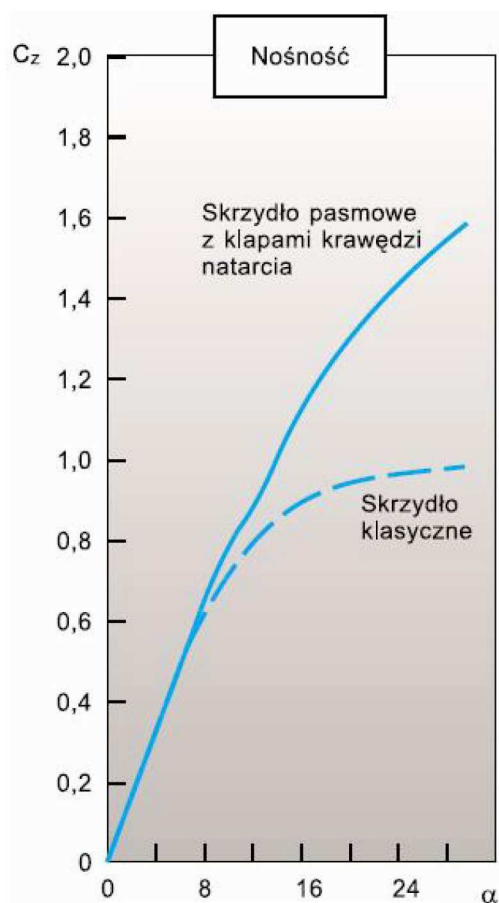
Rys. 5. Zależność współczynnika siły nośnej od kąta natarcia dla skrzydeł pasmowych z klapami krawędzi natarcia i dla skrzydeł klasycznych
