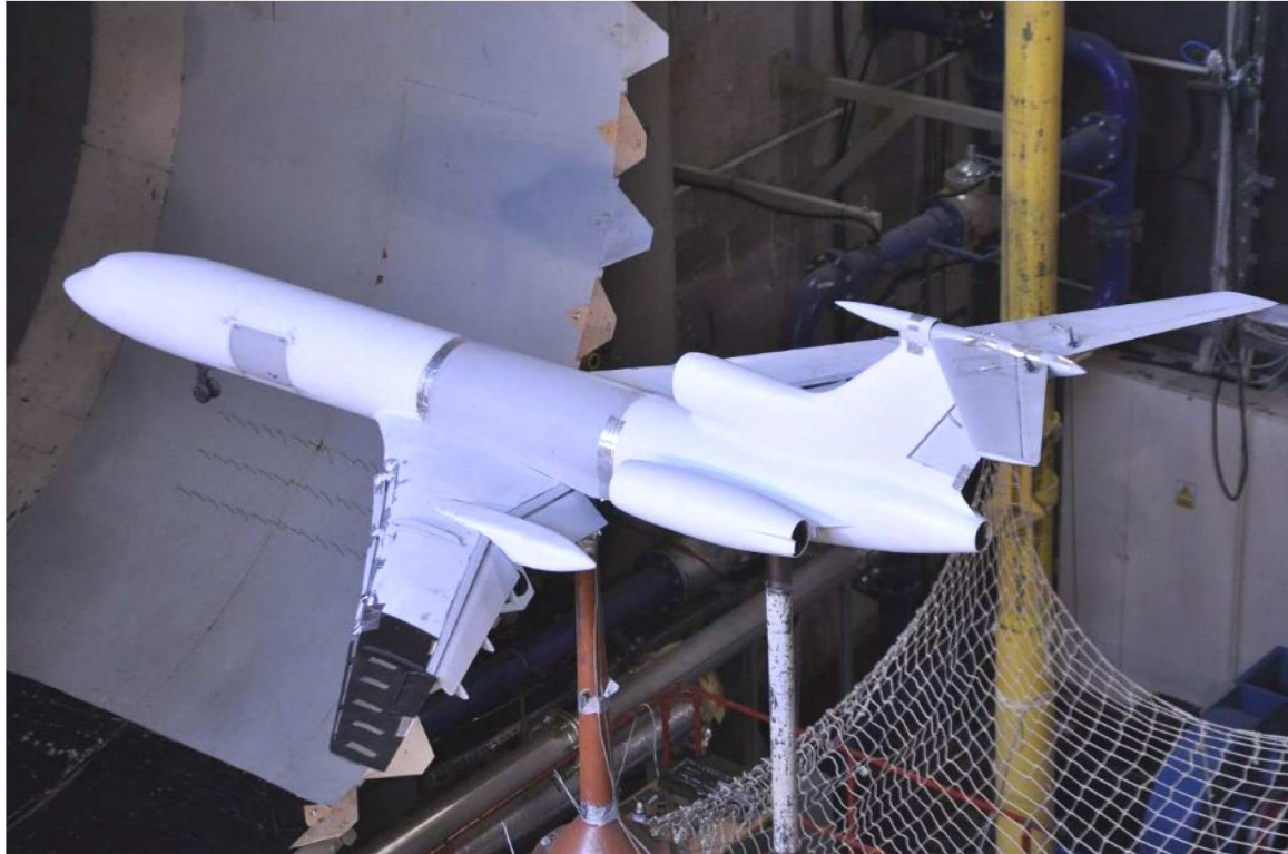
Rys. 4. Model samolotu Tu-154M w skali 1:14 w tunelu T-3 Instytutu Lotnictwa
