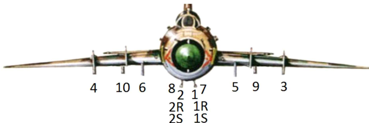
Rys. 5. Stanowiska broni pokładowej samolotu Su-22 (opis w tekście) [21]
