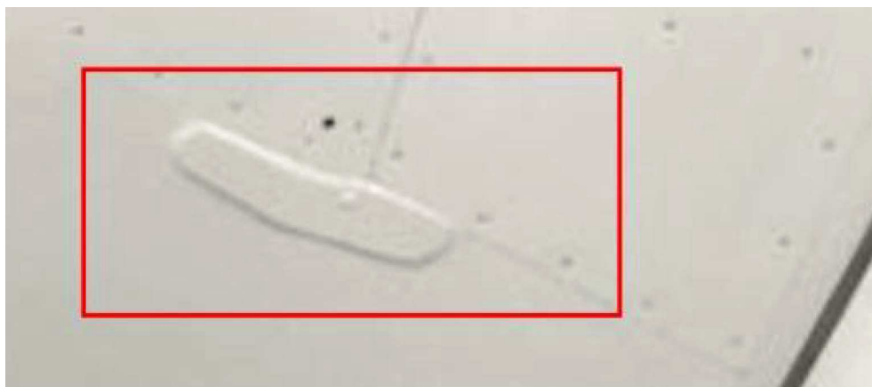
Rys. 2. Naprawa wykryta w trakcie inspekcji samolotu
