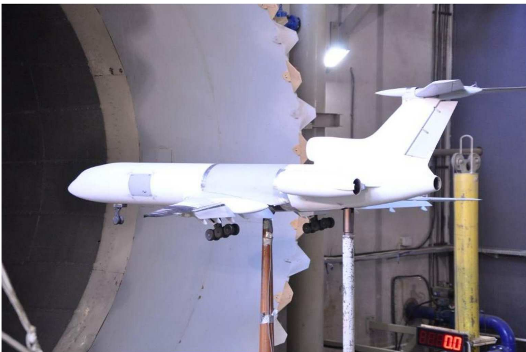
Rys. 2. Zamocowanie modelu samolotu Tu-154 M w tunelu T-3
