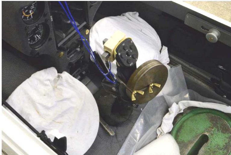
Rys. 3. Masa zastępcza (1 kg) zamocowana do drążka podczas badań rezonansowych szybowca
