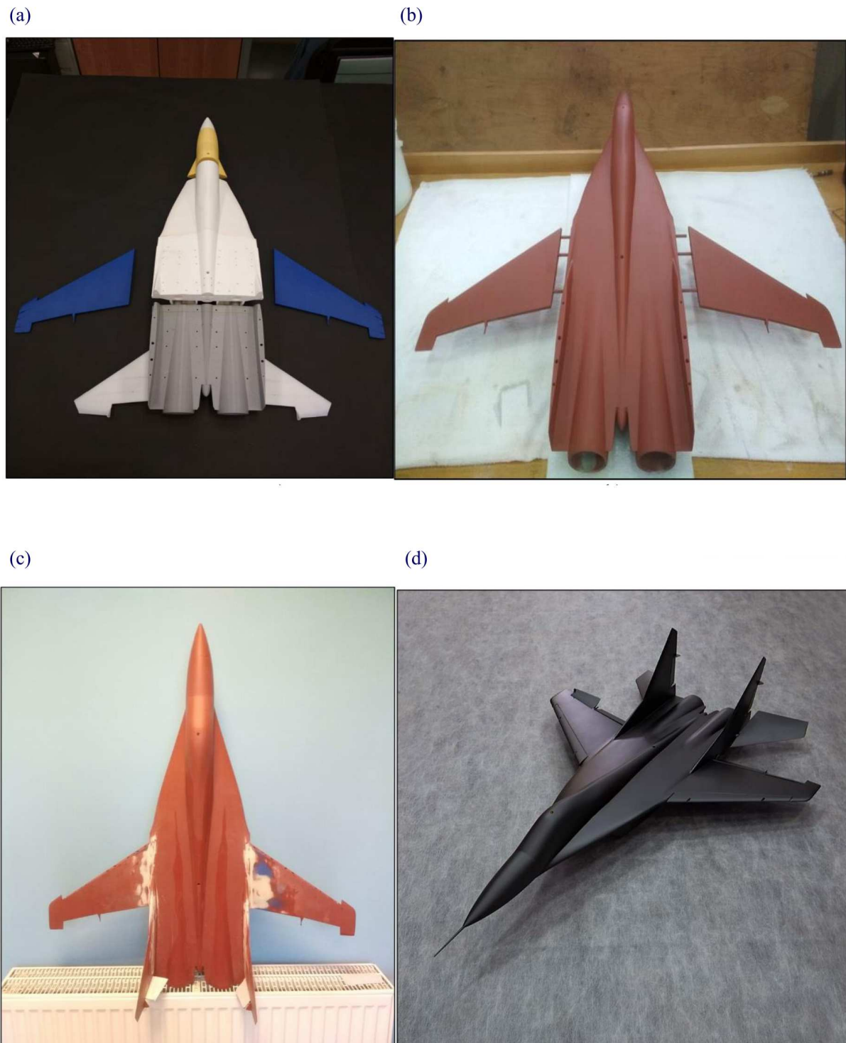
Rys. 6. Etapy tworzenia modelu rzeczywistego samolotu MiG-29 do badań tunelowych: (a) wydrukowane elementy samolotu, (b) łączenie kadłuba ze skrzydłami, (c) wypełnienie szczelin montażowych w płaszczyznach łączenia skrzydeł z kadłubem, (d) model końcowy w skali 1:15
