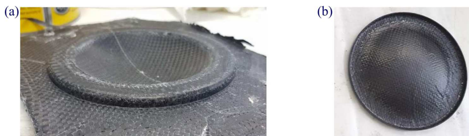
Rys. 14. (a) Próbka półfabrykatu tarczy tylnej, (b) tarcza tylna po obróbce
