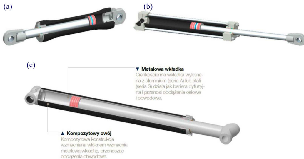
Rys. 5. Siłownik kompozytowy: (a) – serii C (tuleja cylindra wykonana w całości z materiału kompozytowego), (b) – serii T (całość z materiału kompozytowego z prętami ściągającymi), (c) – serii A i S (cienkościenna tuleja wykonana ze stali lub aluminium i wzmocniona kompozytami [8])
